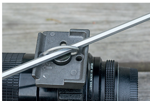
Skruva i skruven för hand och efterdra sedan försiktigt med en hävstång.
